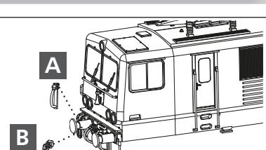
(DE) Beim Betriebseinsatz ist zu beachten, dass die Bremsschläuche die Funktion der Kupplungsdeichsel behindern.
